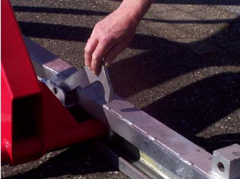
Abb.ML-64: Mekanisk låsning af byggeliften ved ilægning af fangarmen
