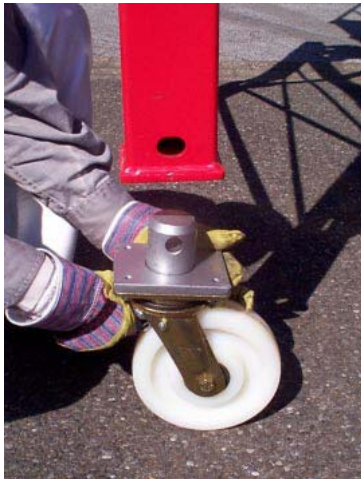
Fig. ML-13: Montering af en styrerulle under drejestøtterne
