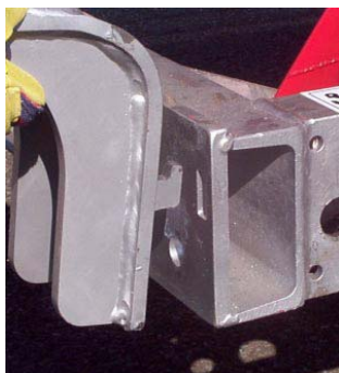
Fig. ML-08: Indhægtning af hjulkonsol
