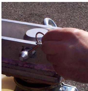
Fig. ML-11 Låsning af kørehjul
