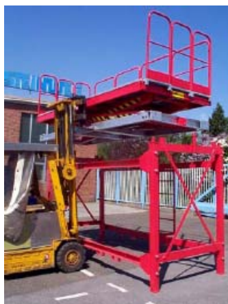
Fig. ML-37: Løft af byggeliften med en gaffeltruck
