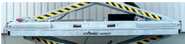
Fig. ML-56: To forbindelsesstøtter på byggeliftens vægside
