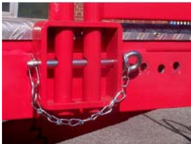
Fig. ML-46: Låsning af de enkelte dele
