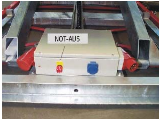
Fig. ML-62: Aktivering og frigivelse af NØDSTOP-knappen
