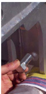
Fig. ML-09 Montering af en hjulkonsol
