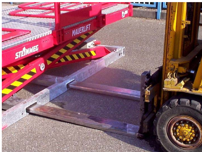
Fig. ML-07 Løft af byggeliftet ved hjælp af gaffeltruck
