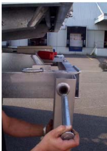
Fig. ML-51: Montering af forbindelsesstøtter med en låsebolt ved hver hjørne på bundrammen.
