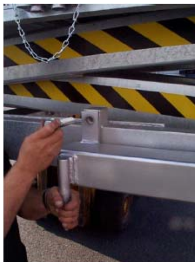
Fig. ML-52: Fiksering af forbindelsesstøtterne på bundrammen.
