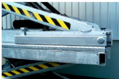
Fig. ML-54: Montering af forbindelsesstøtter på bundrammens hjørner.
