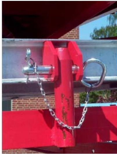
Fig. ML-39: Fiksering på understellet og boltsikring.
