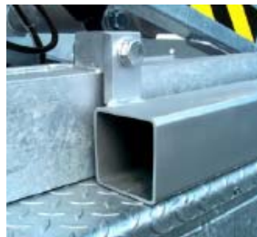
Fig. ML-55: Fastskruning af forbindelsesstøtterne på bundrammen.
