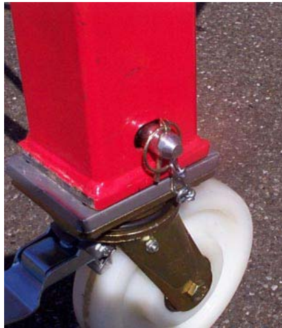
Fig. ML-14: Låsning af styrerullen med en bolt og en låsesplint
