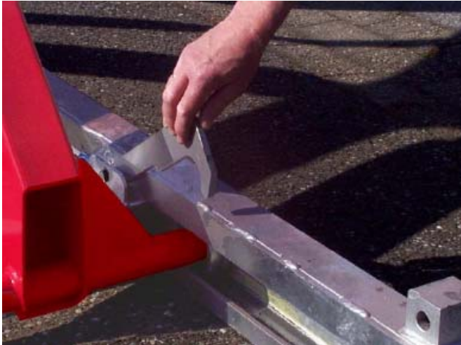
Fig. ML-58: Ilægning af fangarm (eksempel nederste byggelift).
