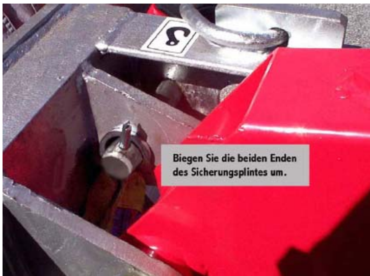
Fig. ML-20: Låsning af boltene med splinterne
