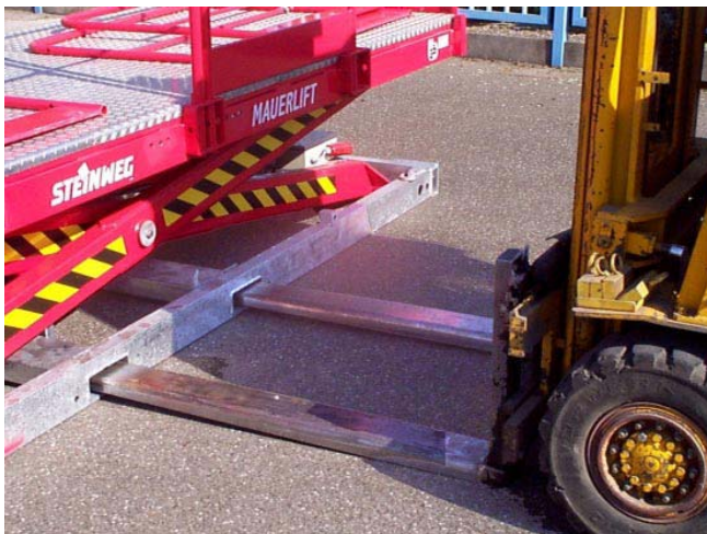
Fig. ML-18 Løft af byggefliften ved hjælp af gaffeltruck
